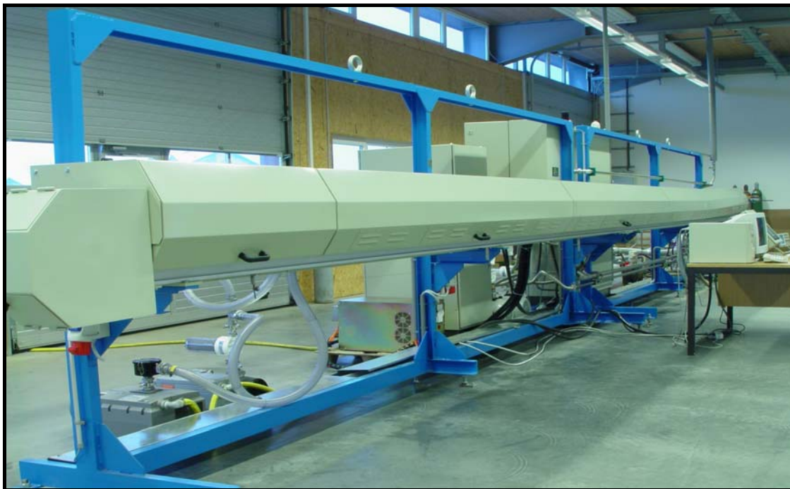
Abbildung 1: Plasmaglühung für Hochgeschwindigkeitsglühen von Nickelbasislegierungsdrähten und Drähten aus Edelstählen.
